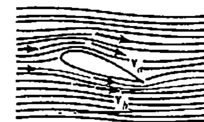
(a) corriente de aire alrededor del ala de un avión; |v_1| > |v_2|
